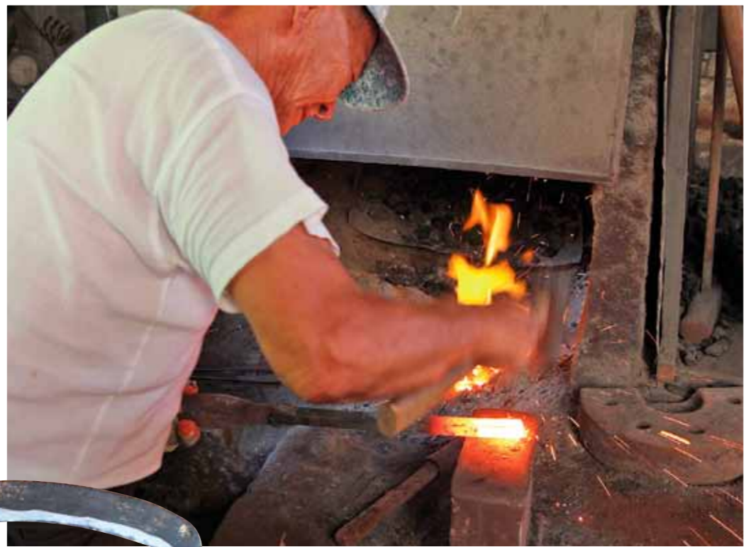
鉄を焼き、鋼と接合する作業。ここから鍛えられていきます。
